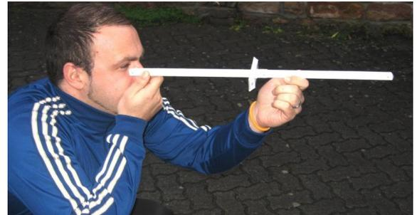
Der **Querstab** muss so auf den Basisstab gesteckt werden, dass die Buchstaben in die gleiche Richtung zeigen (siehe Bild).
